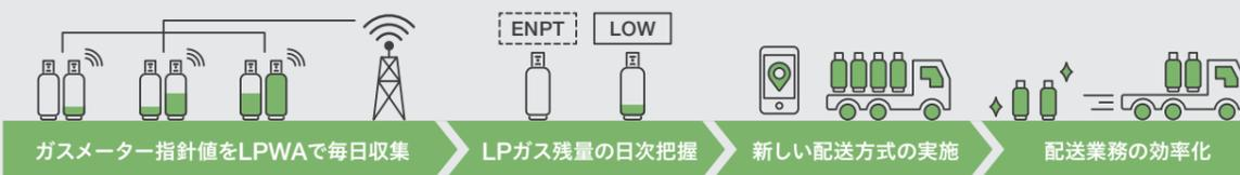
※従来の月1回の定期検針によるガス残量の予測に基づき次回配送日を決定する配送方式と、LPWAにより毎日LPガス容器内のガス残量を把握し、次回交換日を決定する実績をもとにした新しい配送方式の比較・分析。
